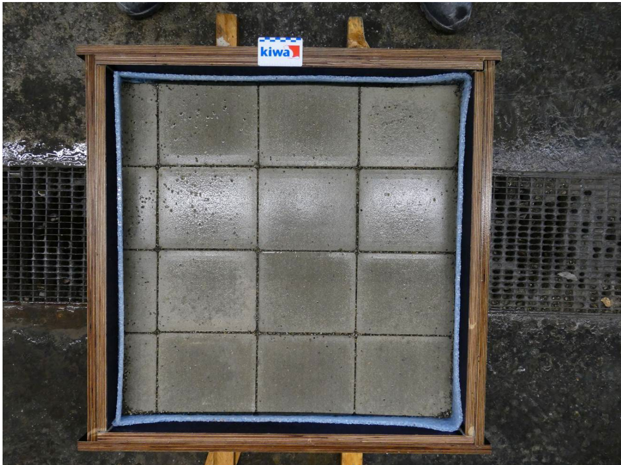
Abbildung 1: Pflastersteine Strada classic mit Fugenmaterial in der Form verlegt (vor der Prüfung)
